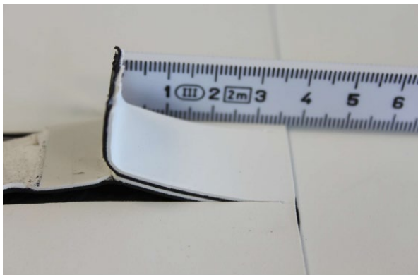
Bild 01: Idealer Abriss bei einer Fugebreite von \geq 2 cm am Beispiel einer Polyfin Duo Bahn
