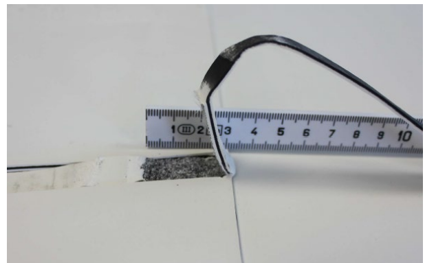
Bild 02: Ideale Delamination innerhalb der Bahn bei einer Fugebreite von \geq 2 cm am Beispiel einer Polyfin Duo Bahn
