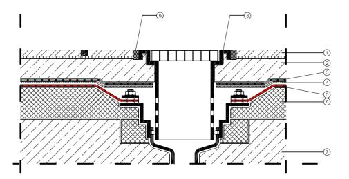
Exemplarisches Detail zur Einbindung eines Entwässerungselementes, einschließlich Darstellung des Schichtenaufbaues:
